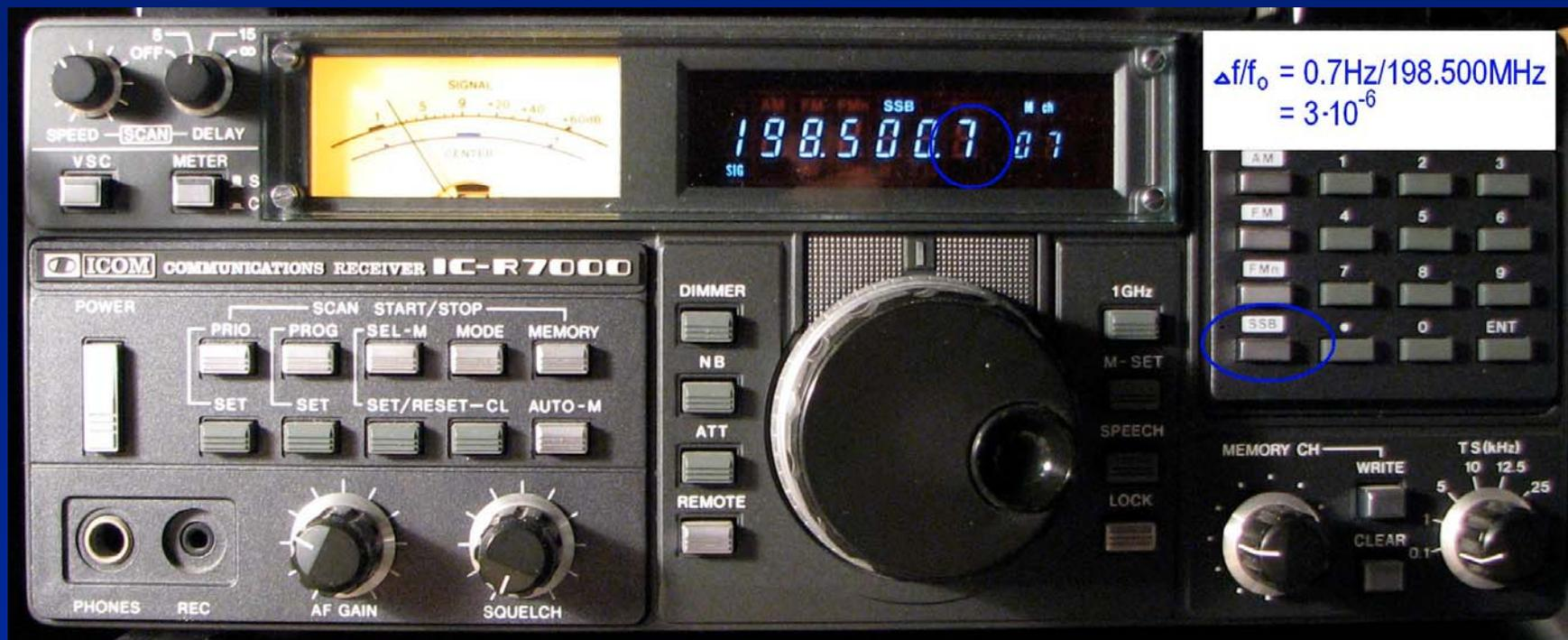
Aufbau einer praktischen Messung mit Empfänger IC R7000 und Ergebnis (Kanal 8: 198.500 000MHz)
